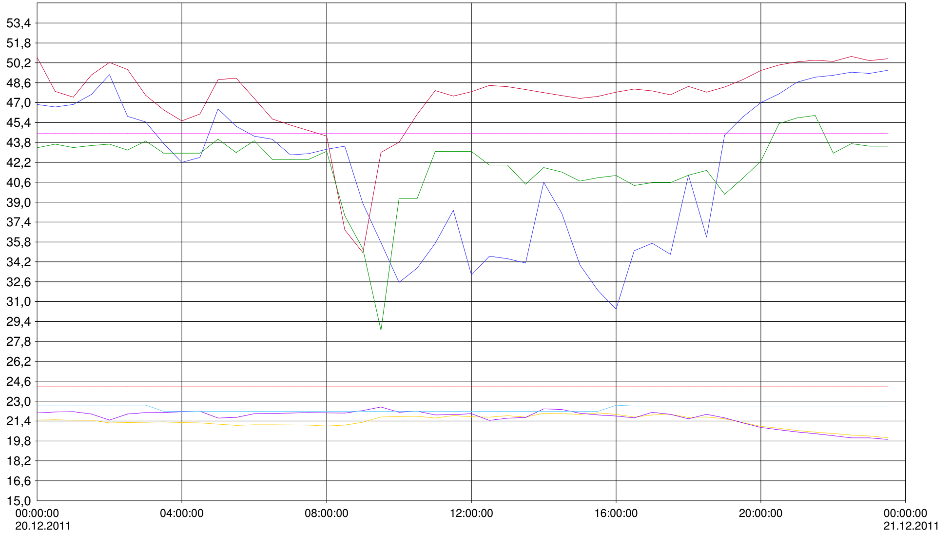
Kunstforum Raumtemperaturen in °C und Raumfeuchte in %rF
